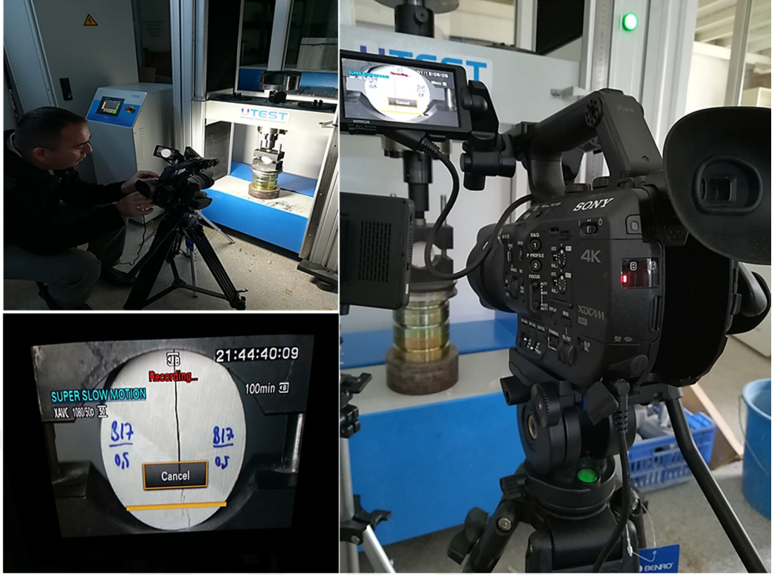
Şekil 4.30. Brezilya deney düzeneği ve hızlı çekim yapan kamera ile çatlak başlangıcının belirlenmesi
