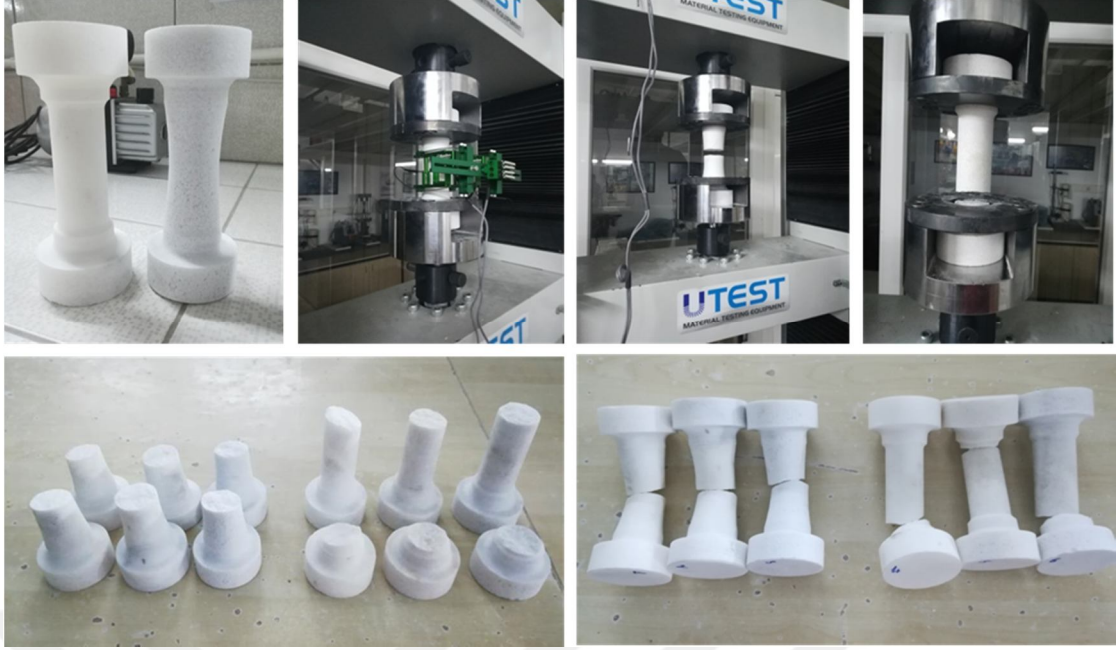
Şekil 4.10. İnce Kristalli mermer numunelerine ait ÇD deney görüntüleri
