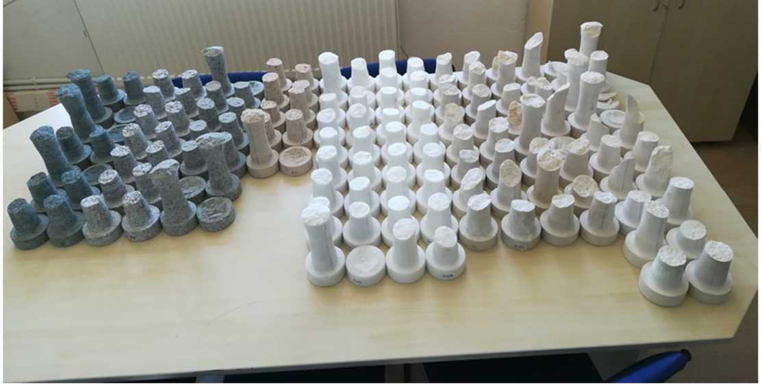
Şekil 4.18. TEÇD deneyleri sonrası numunelerin kırılma durumları
