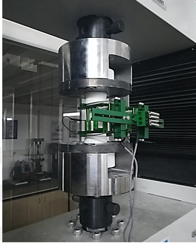
Şekil 3.14. Ekstensometrenin genel görünümü ve numuneye montajı
