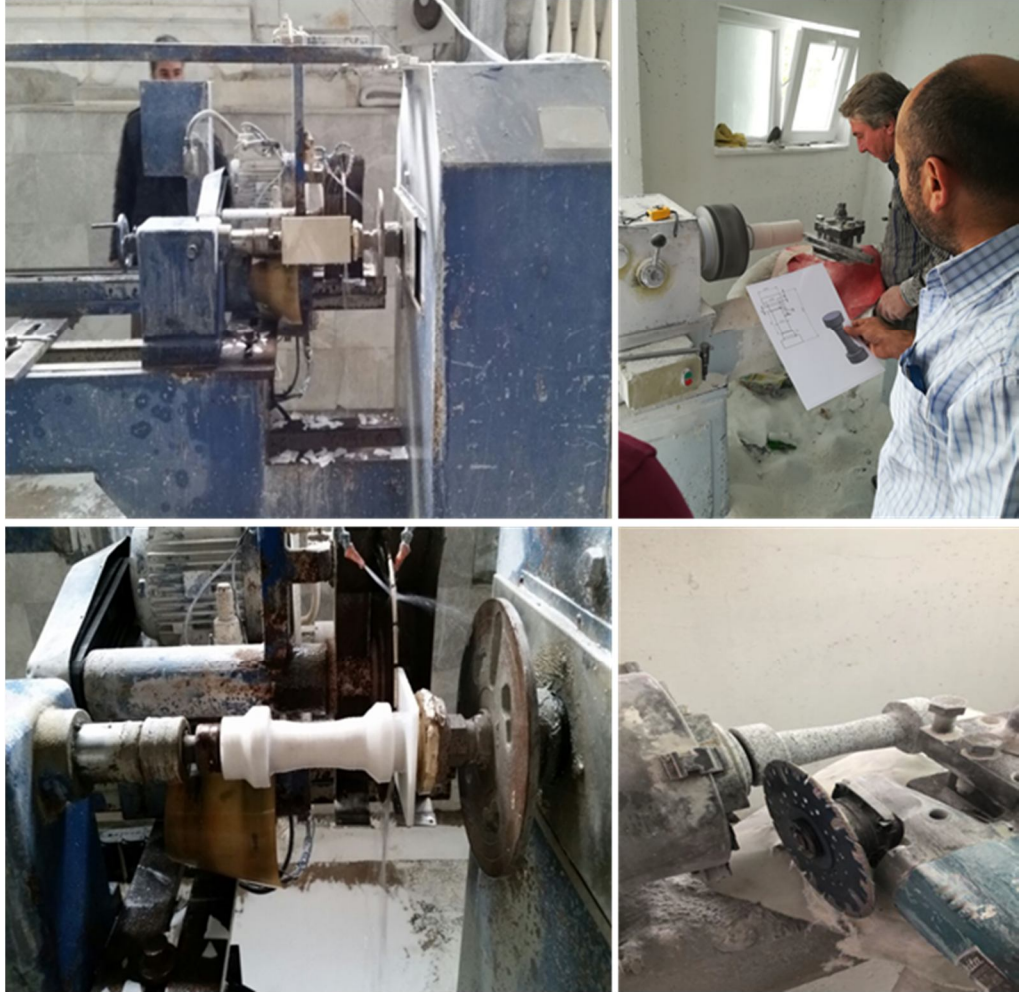
Şekil 3.7. Dambıl şekilli numunelerin tornada hazırlanması
