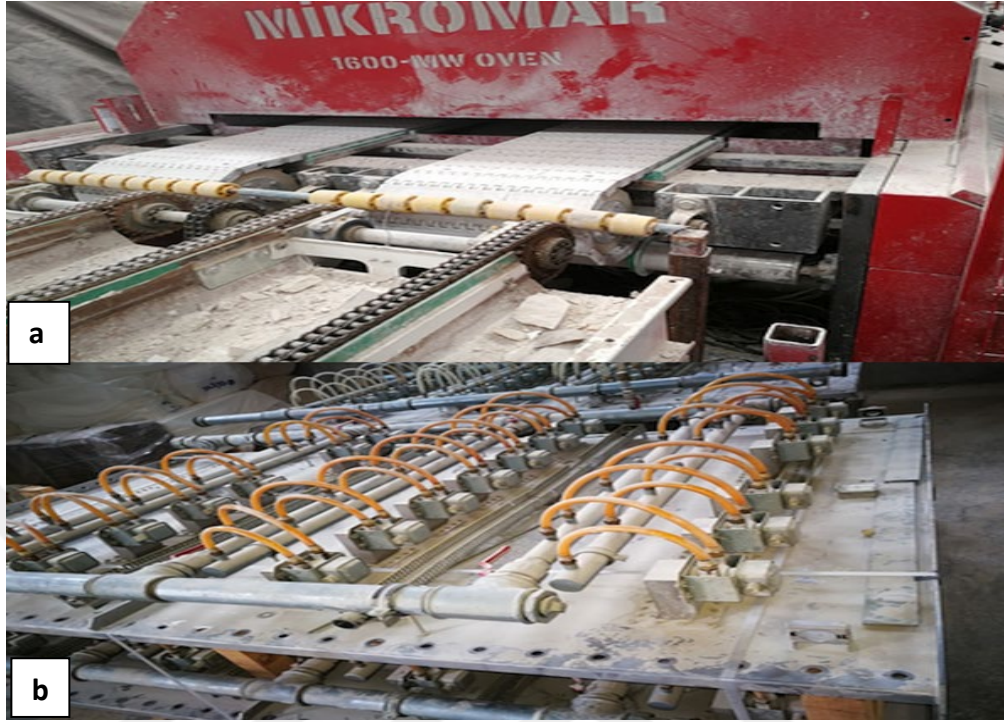
Şekil 3.4. a) Mikro dalga fırın hat ve b) magnetron tüpler
