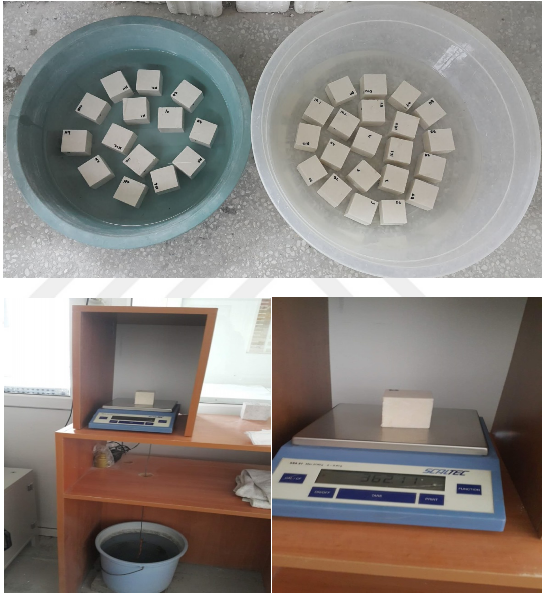
Şekil 3.7. Numunelerin KBHA, ASE ve HSE deneylerinin genel görünümü
