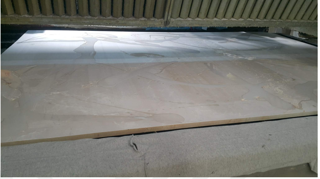
Şekil 1.6. Ön kurutma sonrası epoksi uygulaması
