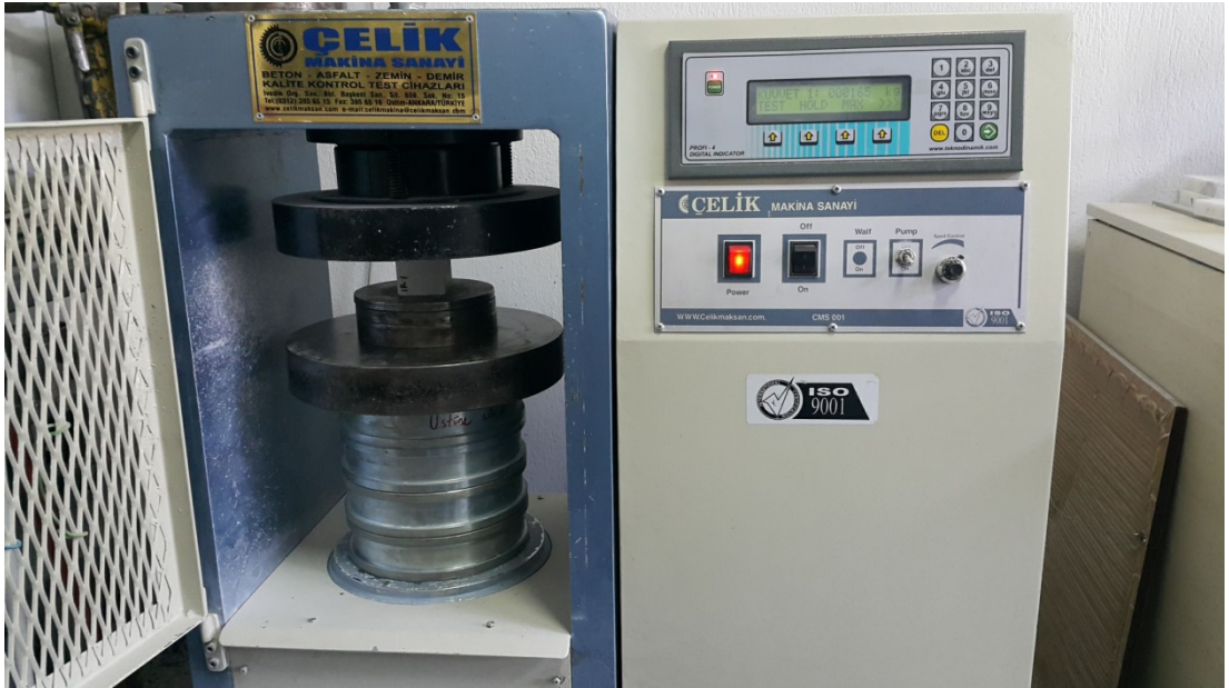
Şekil 3.9. Kayaçların TEBD değerlerinin belirlenmesi
