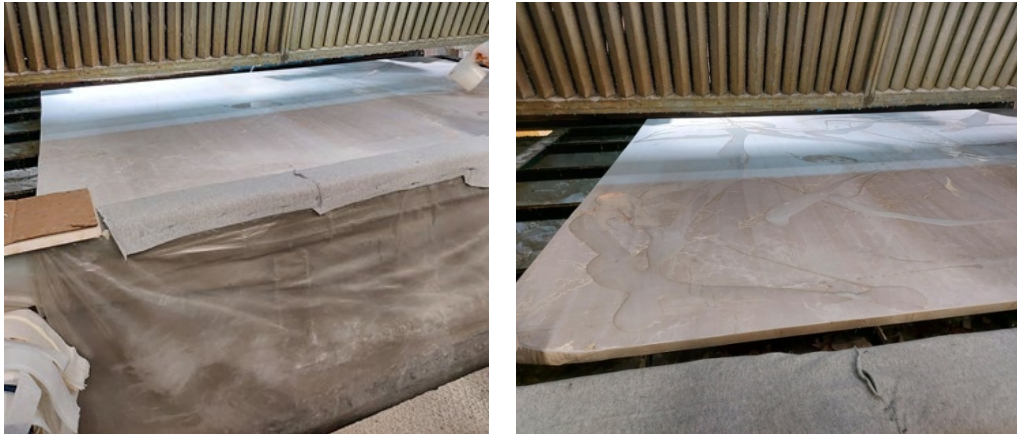
Şekil 1.3. Epoksi uygulama işlemi
