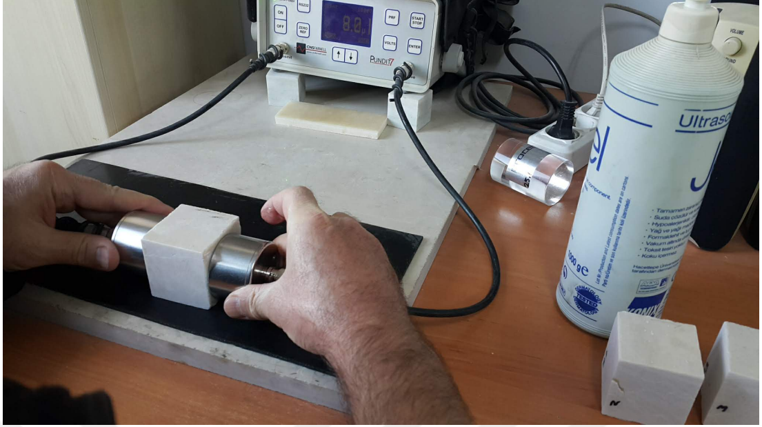
Şekil 3.8. Kayaçların P dalga hızı değerlerinin belirlenmesi
