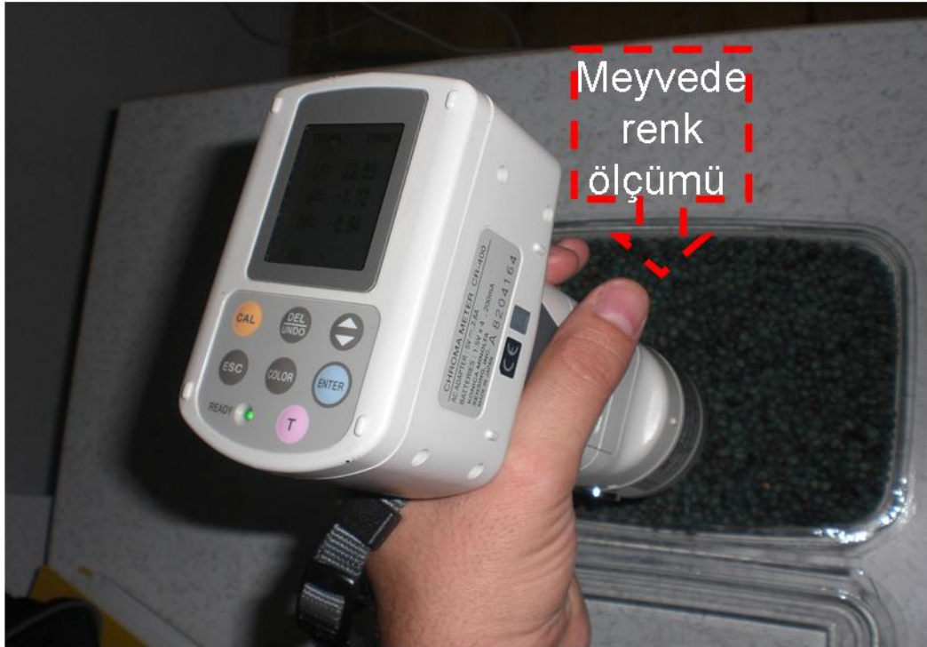
řekil 3.5. Konica Minolta Chroma Meter CR-400 ler cihazı vasıtasıyla meyve renginin llmesi
