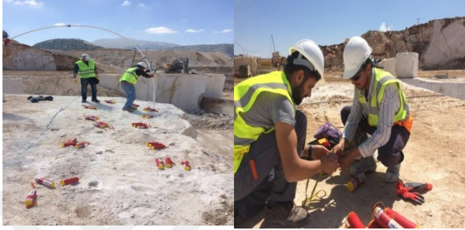
Şekil 3.6. Piroteknik kaya kırıcıların delik içine yerleştirilmesi ve dirençlerinin ölçülmesi
