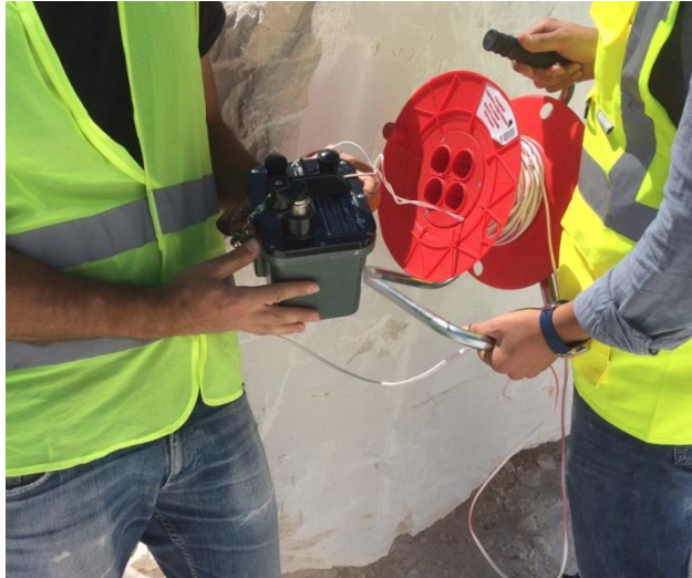
Şekil 3.7. Piroteknik kaya kırıcıların manyeto ile ateşleme işlemi
