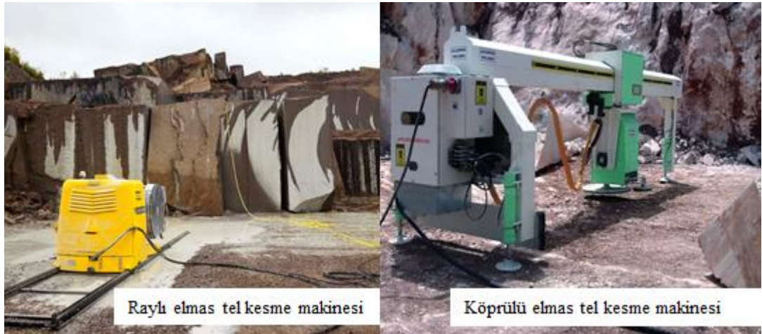
Şekil 3.3. Raylı ve köprülü elmas tel kesim makinaları
