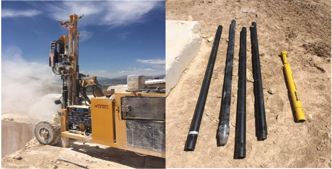
Şekil 3.1. Delik delme işleminde kullanılan delici, tij takımı, tabanca ve bit
