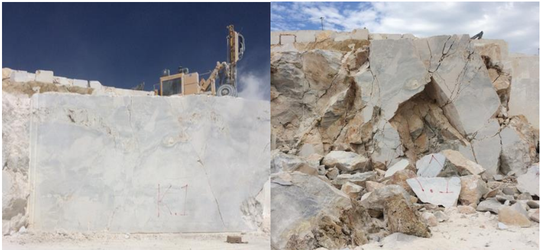
Şekil 4.12. Gevşetme öncesi ve sonrası aynanın genel görünümü
