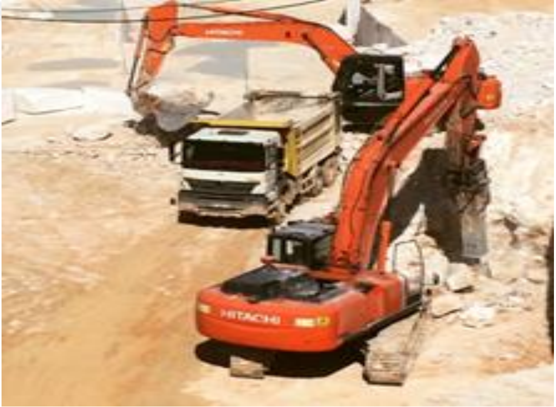
Şekil 1.3. Hidrolik kırıcı ve pasanın yüklenme durumu
