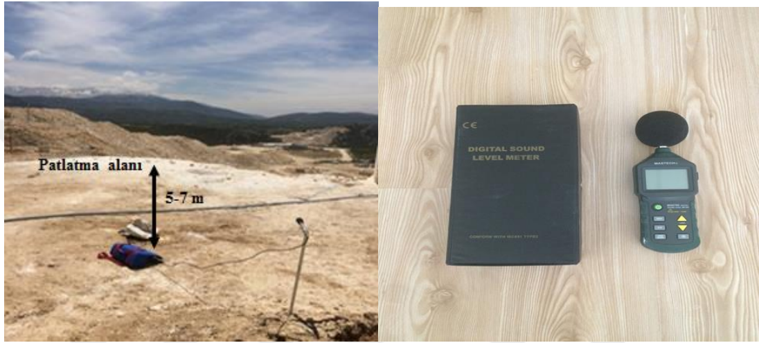
Şekil 4.16. Ses ve titreşim ölçer cihazları
