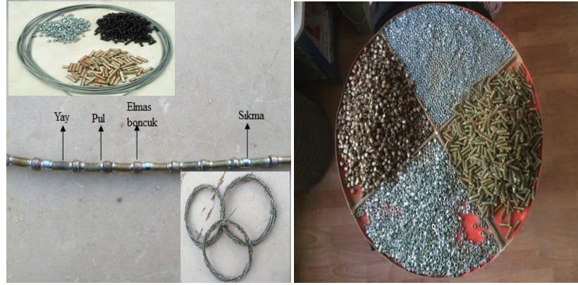
Şekil 3.4. Sinterize elmas tel ve sinterize elmas teli oluşturan parçaları
