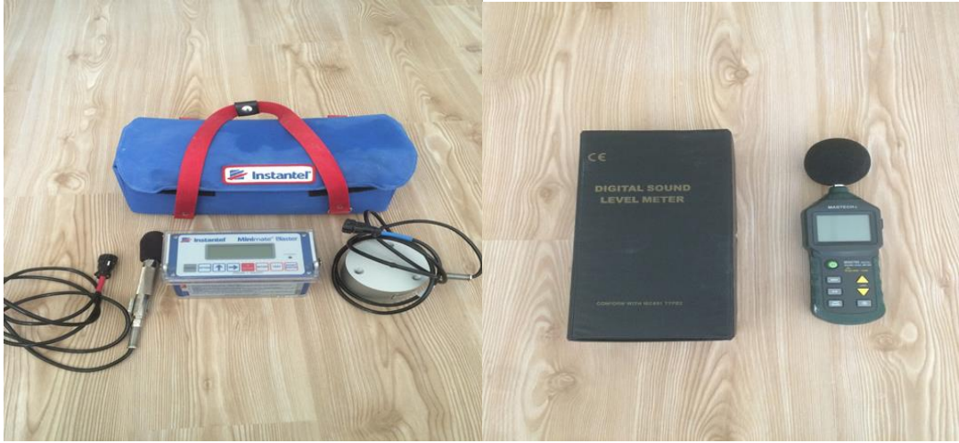
Şekil 3.9. Titreşim ve ses ölçerler
