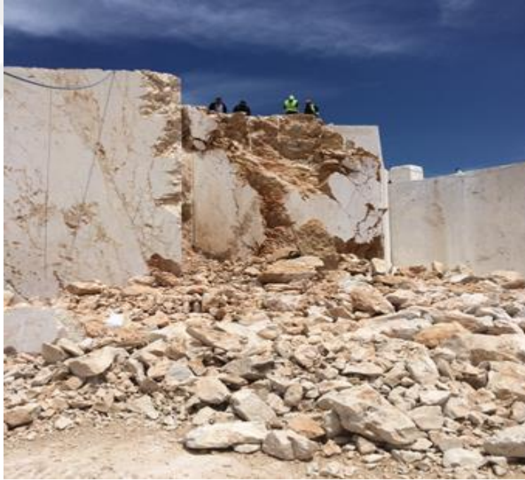
řekil 3.8. Piroteknik kaya kırıcı kullanımından sonraki parça boyutları
