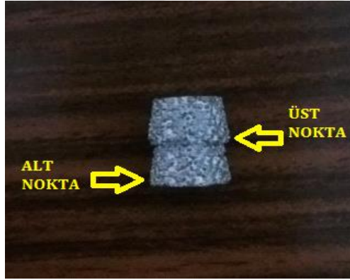
Şekil 2.3. Elmas boncuk üst ve alt noktalar
