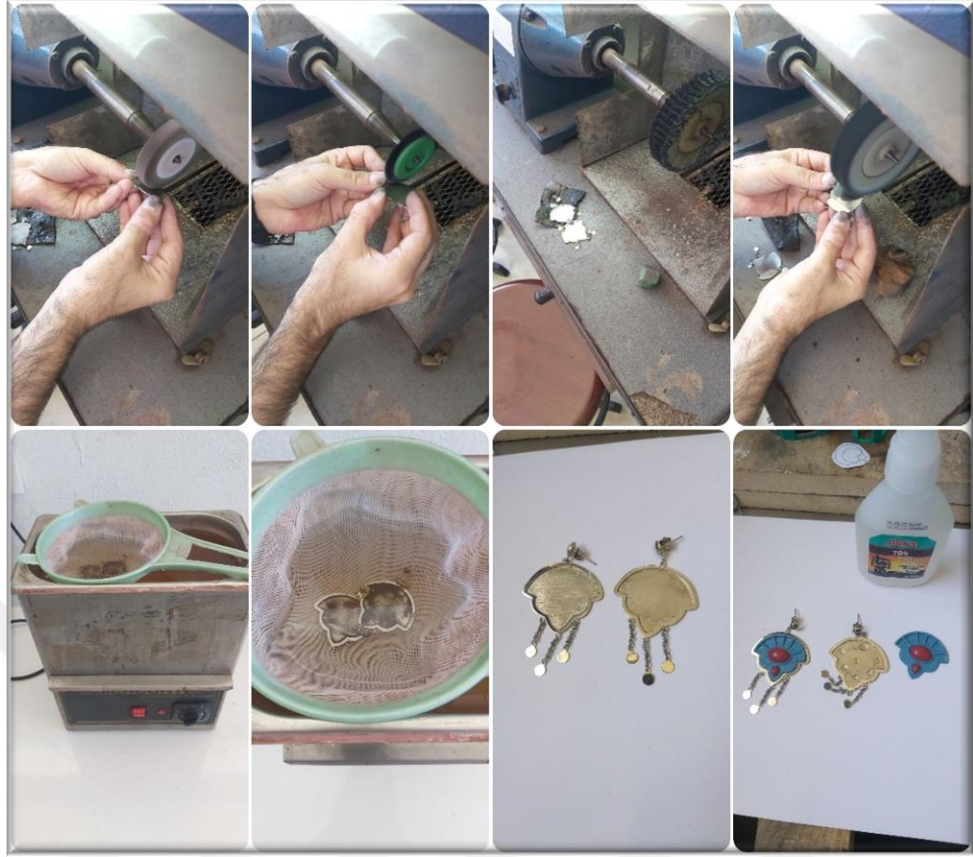
Görsel 66.: Seramik Küpe Yapımında Cila İşlemi ve Takı Parçalarının Sabitlenmesi (Türkyılmaz, 2024).
