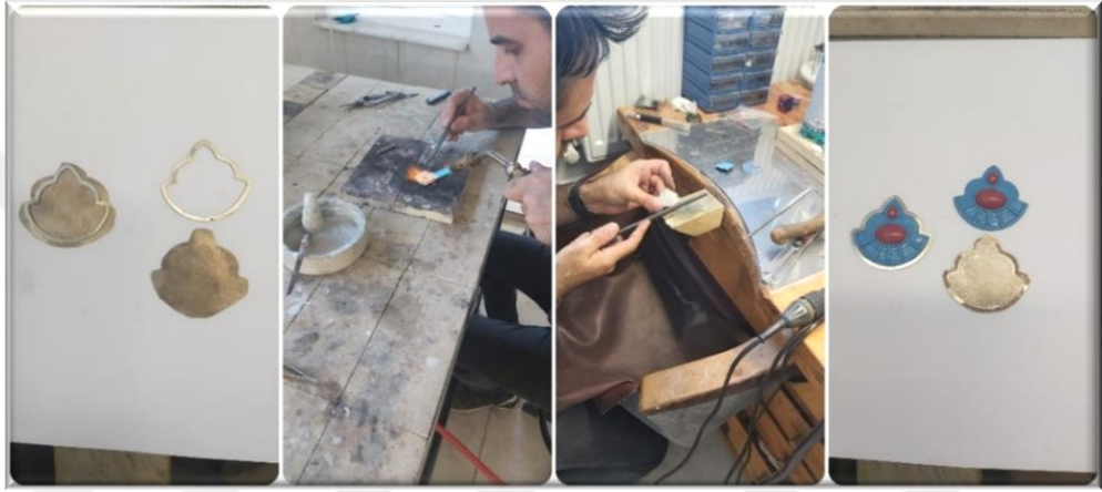
Görsel 64.: Seramik Küpe Yapımında Kafes Kaynak ve Tesviye İşlemi (Türkyılmaz, 2024).
