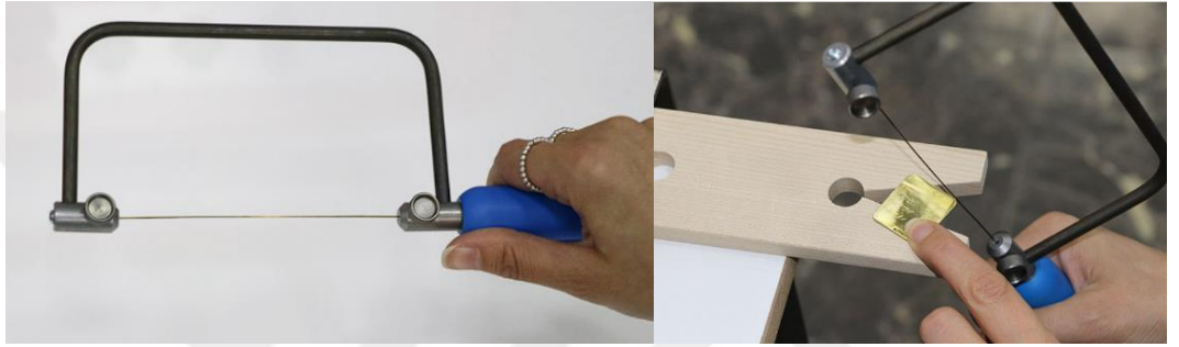
Görsel 44.: Kıl Testere (Solda) ve Kıl Testereyle Kesim İşlemi (URL-42).
