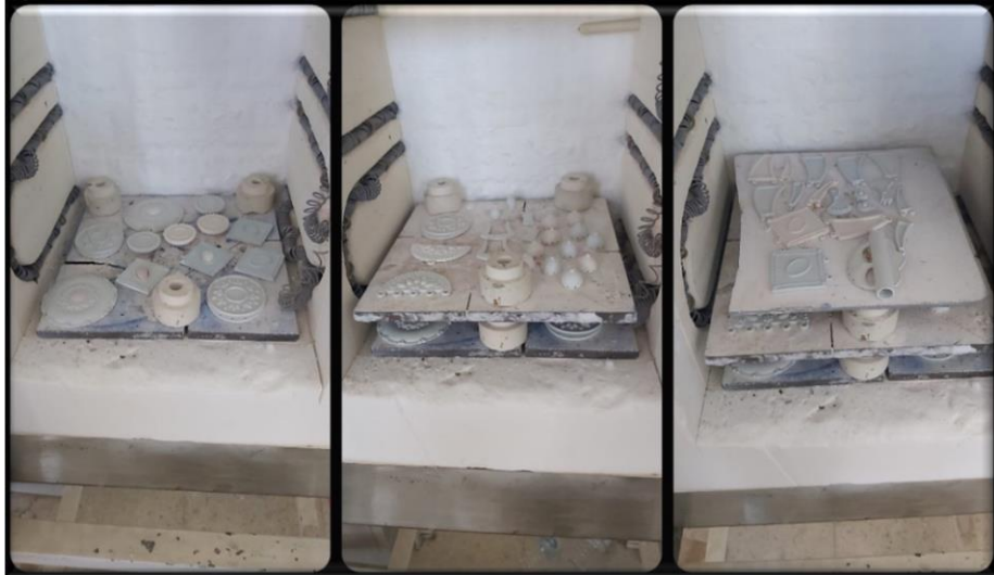
Görsel 61.: Seramik Takı Parçalarının Fırına Yerleştirilmesi (Türkyılmaz, 2024).
