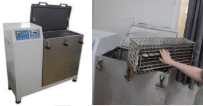
Şekil 92: (a) Su emme testi için kullanılan Vakumlu Su Emme test cihazı ve (b) Vakumlu Su Emme Test cihazına tabletlerin test için yerleştirilmesi
