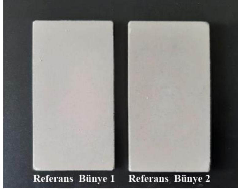
Şekil 94: Referans Bünye Reçetesi 1 ve Referans Bünye Reçetesi 2 tabletleri pişme sonrası görünüşleri
