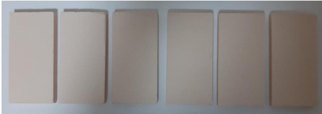
Şekil 147: Pegmatit yerine PDKA'nın kullanıldığı Duvar Karosu Bünye Denemeleri (soldan sağa) Referans Duvar Karosu Bünye Reçetesi ve sırasıyla PDKA' lı Duvar Karosu Deneme 1, 2, 3, 4, 5 reçete tabletleri pişme sonrası görünüşleri
