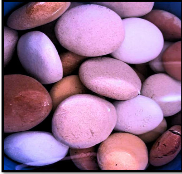
Şekil 28. Pişmiş Kil Örneklerinin 12 Saat Suda Bekletilmesi (Hasekioğlu, Kişisel Arşiv 2023).
