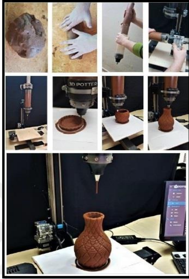
Şekil 25. Geleneksel yöntemlerle hazırlanan ve ekstrüzyon uygunluğu tespit edilen kilin 3B yazıcıda çıkarılış aşamaları ve form görüntüsü (Ünal ve Hasekioğlu, 2023:832).
