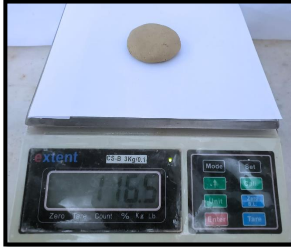
Şekil 27. Kil örneğinin tartılması (Hasekioğlu, Kişisel Arşiv 2023).
