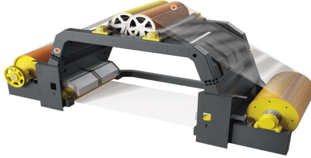
Şekil 1.16. Elmas telli katrağ üçgensel geometri bileşenleri (Hedel, 2024)
