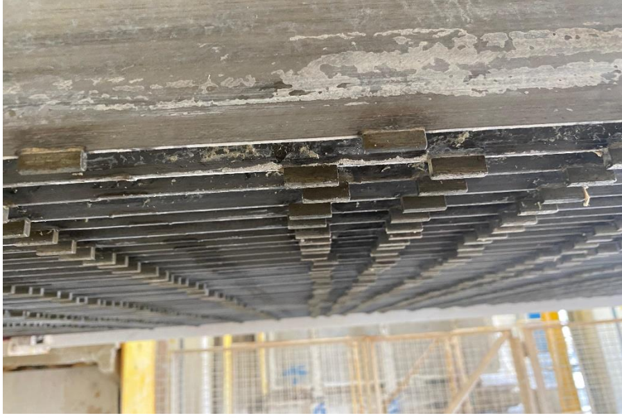
Şekil 2.3. Verilerin alındığı 7 nolu karak lama segment dizilimi
