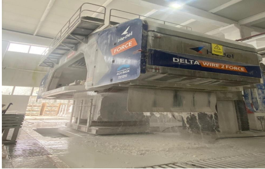
Şekil 2.4. Verilerin alındığı 76 telli 1 nolu elmas telli katraş makinesi
