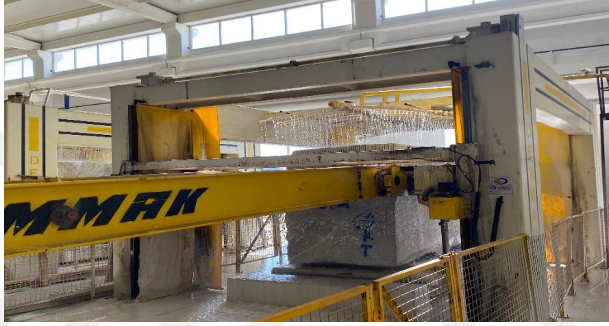
Şekil 2.2. Verilerin alındığı 7 nolu lamalı katraç makinesi
