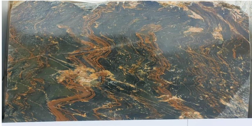
Şekil 3.4. Katrakta kesilmiş kalsitli mermerin görünümü
